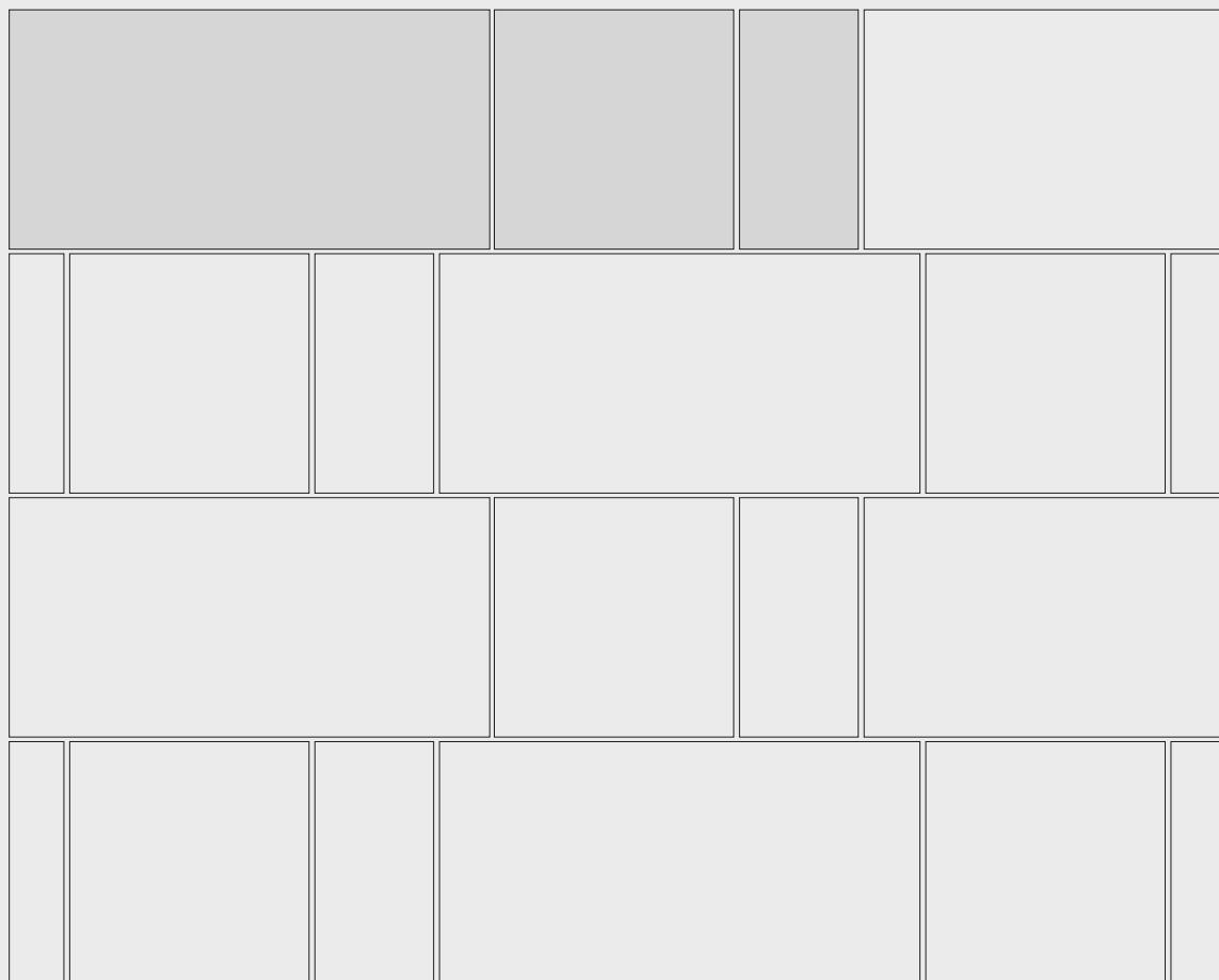
**Se si seguono gli schemi a.1 e a.2 il materiale deve essere posato con fuga fissa di 3 mm.**
